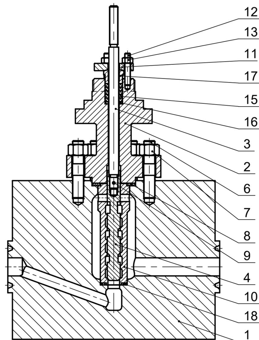
Клапан с неразгруженным плунжером
