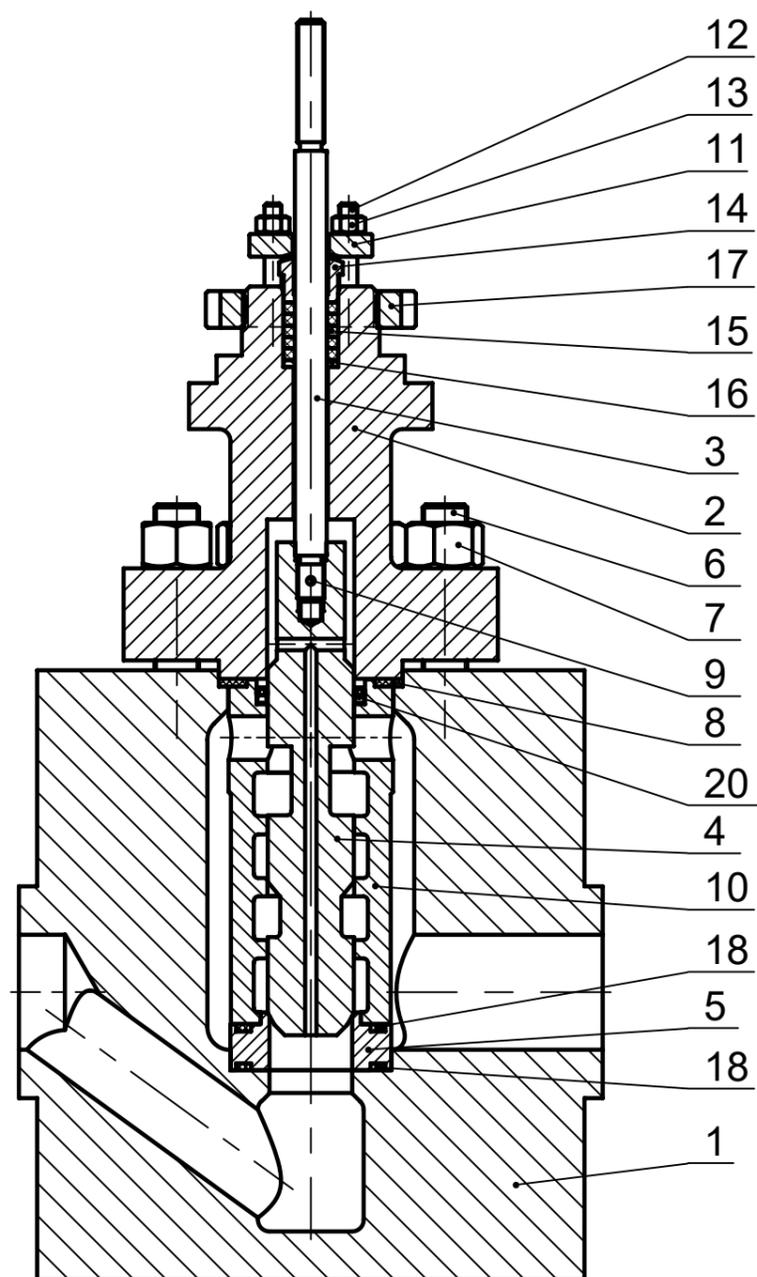
Клапан с разгруженным плунжером
